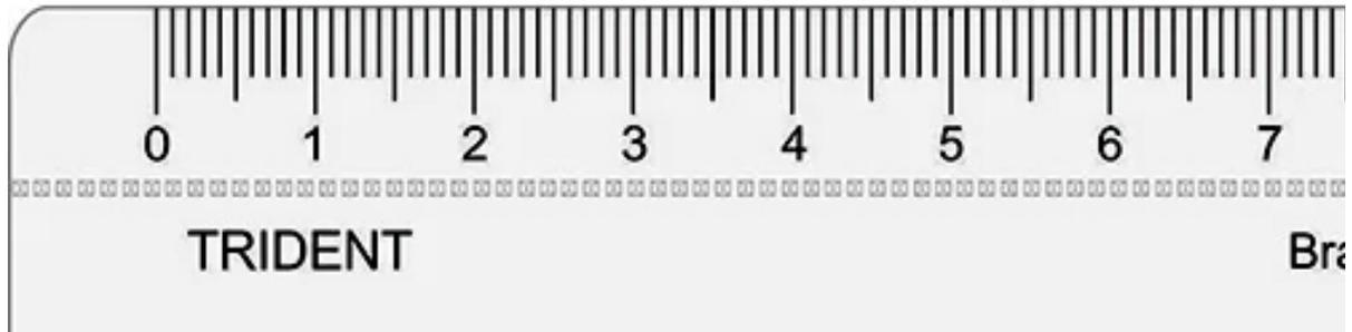
Podemos perceber que nesta escala real, 1/1, o escalímetro torna-se uma régua comum, sendo, cada centímetro valendo 1 centímetro.
