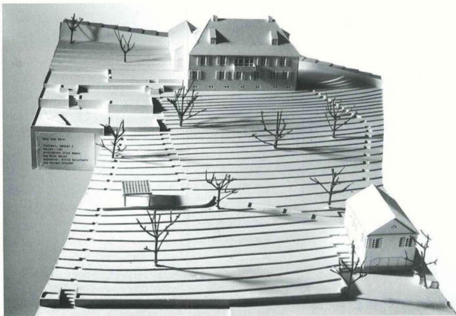
79. Maqueta de un edificio con su entorno, 1:100. Base: tablero de madera aglomerada de 13 mm de espesor; estratos del terreno: cartón de 2 mm de espesor; edificios: cartón de 1 y 2 mm de espesor en el que se han recortado las ventanas y se han dibujado las persianas; ventanas: papel gris con la carpintería pintada en blanco y pegado a la cara interior de las fachadas; vegetación: pequeñas ramas.
