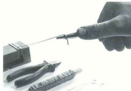
181. El alambre que utilizamos nosotros tiene de 0,2 a 1,2 mm de grosor y ha de estirarse antes de soldarlo.
