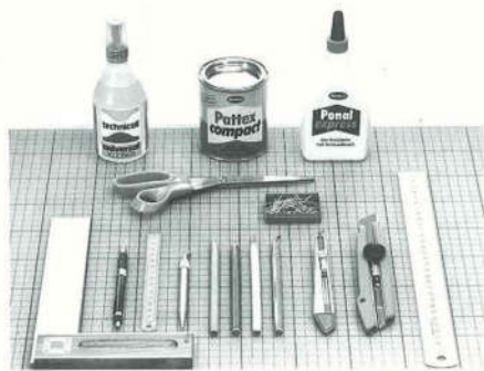
34. Herramientas para trabajar con papel y cartón: escuadra metálica, regla de acero, punzones, agujas, cutters, tijeras y pegamentos.
