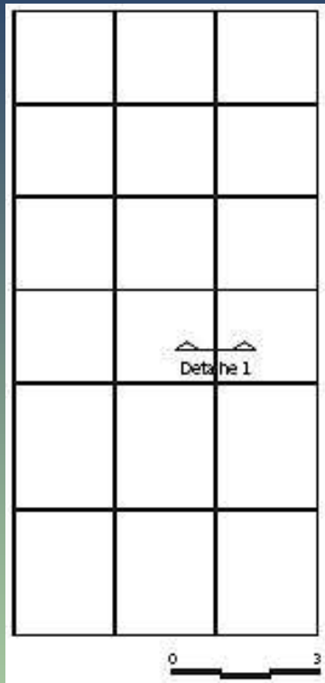
Figura 4 – Fachada cortina: pele de vidro da fachada lateral direita
