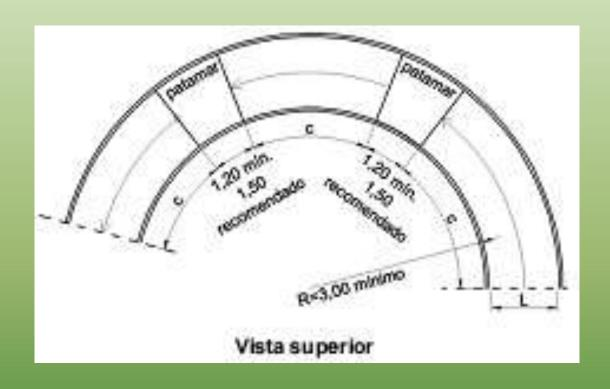
Para rampas em curva, a inclinação máxima admissível é de 8,33% e o raio mínimo de 3,00 m, medido no perímetro interno à curva, conforme figura ACIMA.
