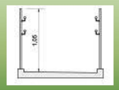
As escadas e rampas que não forem isoladas das áreas adjacentes por paredes devem dispor de guardacorpo associado ao corrimão, conforme figura ACIMA, e atender ao disposto na ABNT NBR 9077.
